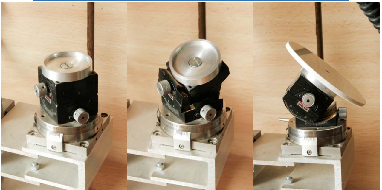
Goniómetros cruzados con rotatorio 3 ejes de giro, el horizontal de 360°
